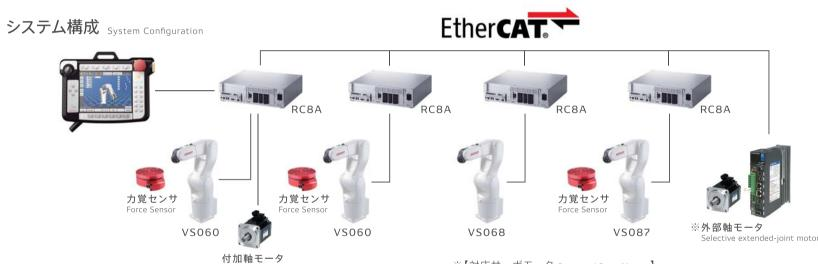
※【対応サーボモータ Supported Servo Motors 】 山洋電気(型式:SANMOTION R ADVANCED MODEL EtherCAT) Sanyo Denki (Model: SANMOTION R ADVANCED MODEL EtherCAT)
